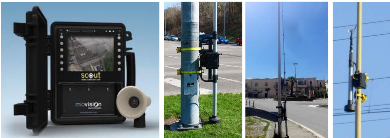
Figura B3 – Unità di rilevamento con schermo LCD da 5,6" e obiettivo telescopico. Unità di rilevamento posizionata a terra ed in quota
