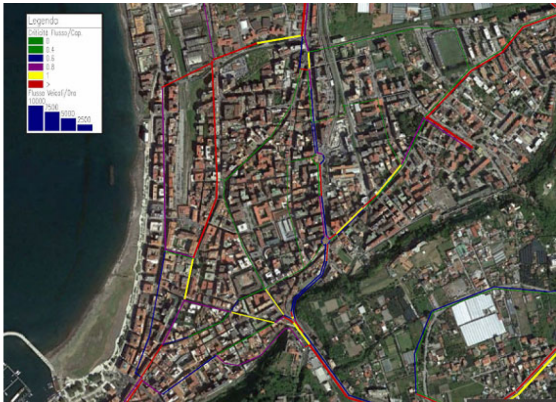
Figura 5.3 – Distribuzione dei flussi e grado di congestione degli archi. Fase di cantierizzazione 1: ora di punta della mattina
