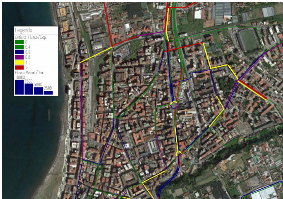
Figura 5.8 – Distribuzione dei flussi e grado di congestione degli archi. Fase di cantierizzazione 3: ora di punta della sera
