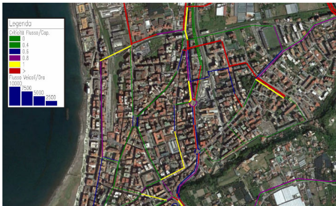
Figura 5.6 – Distribuzione dei flussi e grado di congestione degli archi. Fase di cantierizzazione 2: ora di punta della sera
