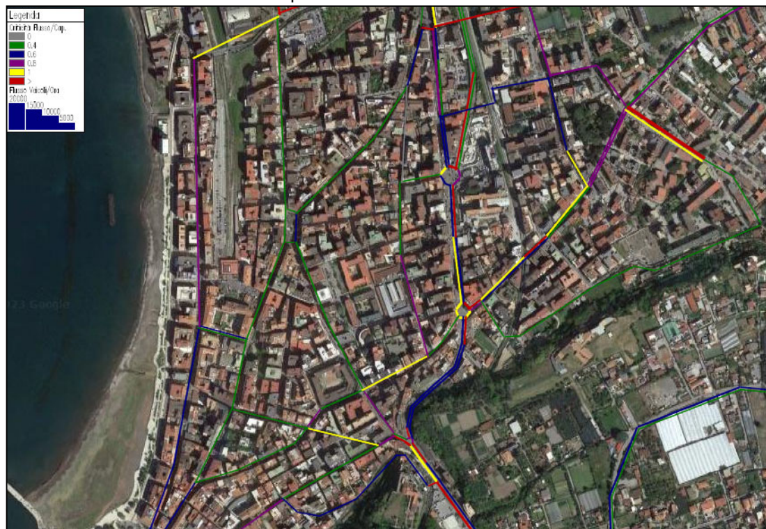
Figura 5.4 – Distribuzione dei flussi e grado di congestione degli archi. Fase di cantierizzazione 0: ora di punta della sera
