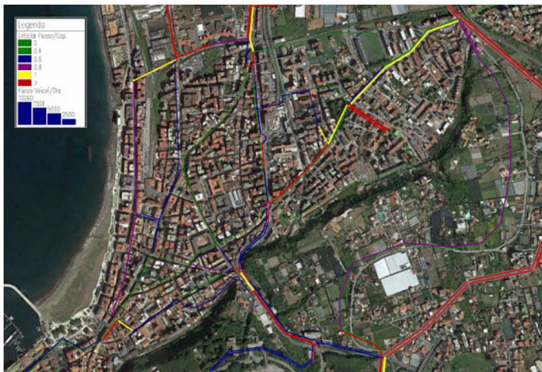
Figura 5.4 – Distribuzione dei flussi e grado di congestione degli archi. Fase di cantierizzazione 1: ora di punta della sera
